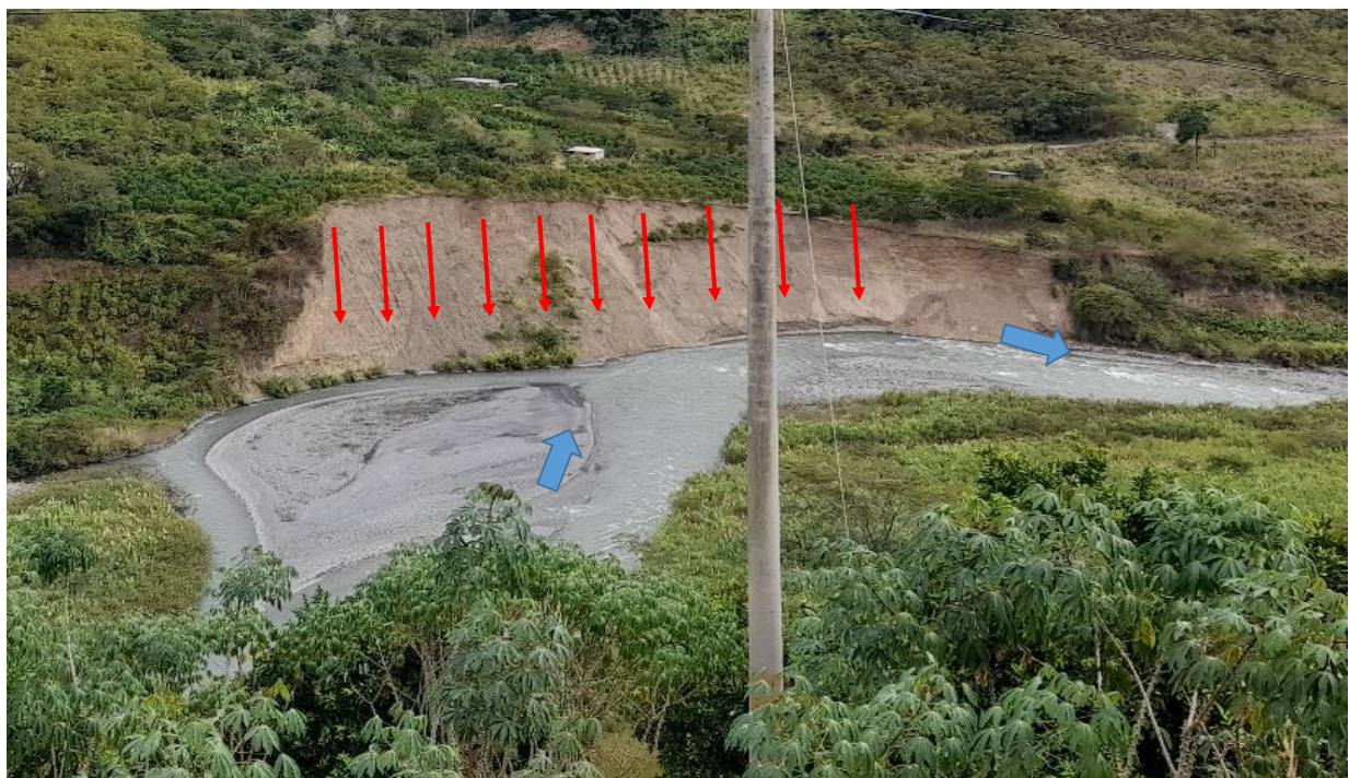
FIGURA N°02: COLAPSO DE AREAS AGRICOLAS POR EROSION MARGINAL DEL RIO YANATILE.
